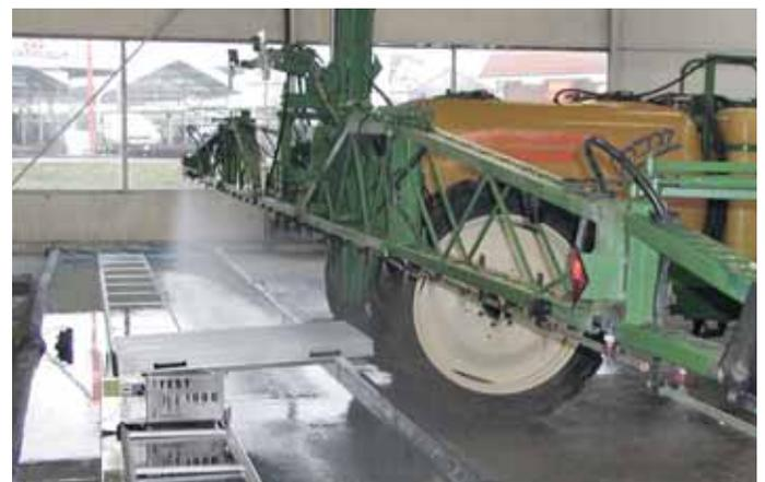
**Auf einem Spritzenprüfstand, wie er auch beim Spritzen-TÜV verwendet wird, lässt sich die Verteilgenauigkeit der Düsen genau überprüfen.**
