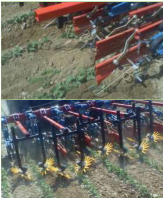
Für die Unkrautregulierung innerhalb der Reihe können beispielsweise Flachhäufler (oben) oder Fingerhacke (unten) zum Einsatz kommen.
