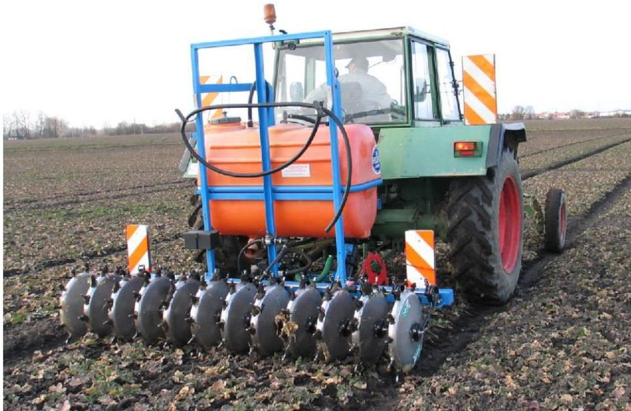
Abb. 7: Injektionsdüngung im Versuch
