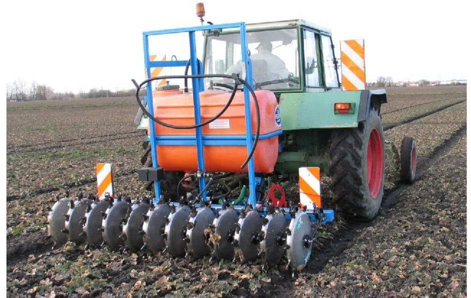
Abb. 7: Injektionsdüngung im Versuch
