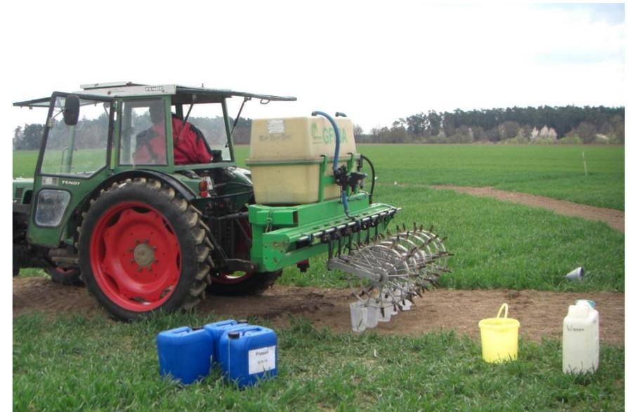
Bild.: Auslitern des Injektionsgerätes vor der Düngung
